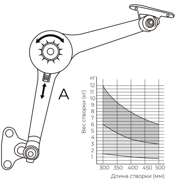
**Назначение:** для открывания вверх и вниз дверей шкафов, изготовленных из дерева или алюминия.
